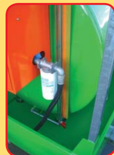
Zárszerkezettel és golyósszeleppel ellátott külső szintkijelző
