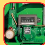
Bemenetnél elhelyezett SAMPI sm7-nx áramlásmérő
